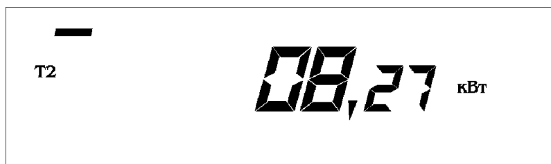
Рисунок 4.12 – Индикация мощности нагрузки
