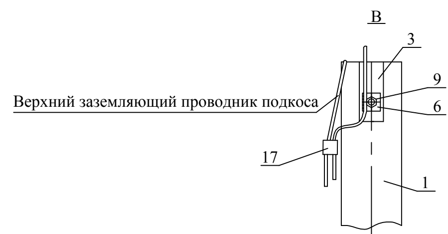
Схема установки опоры на ВЛЗ
