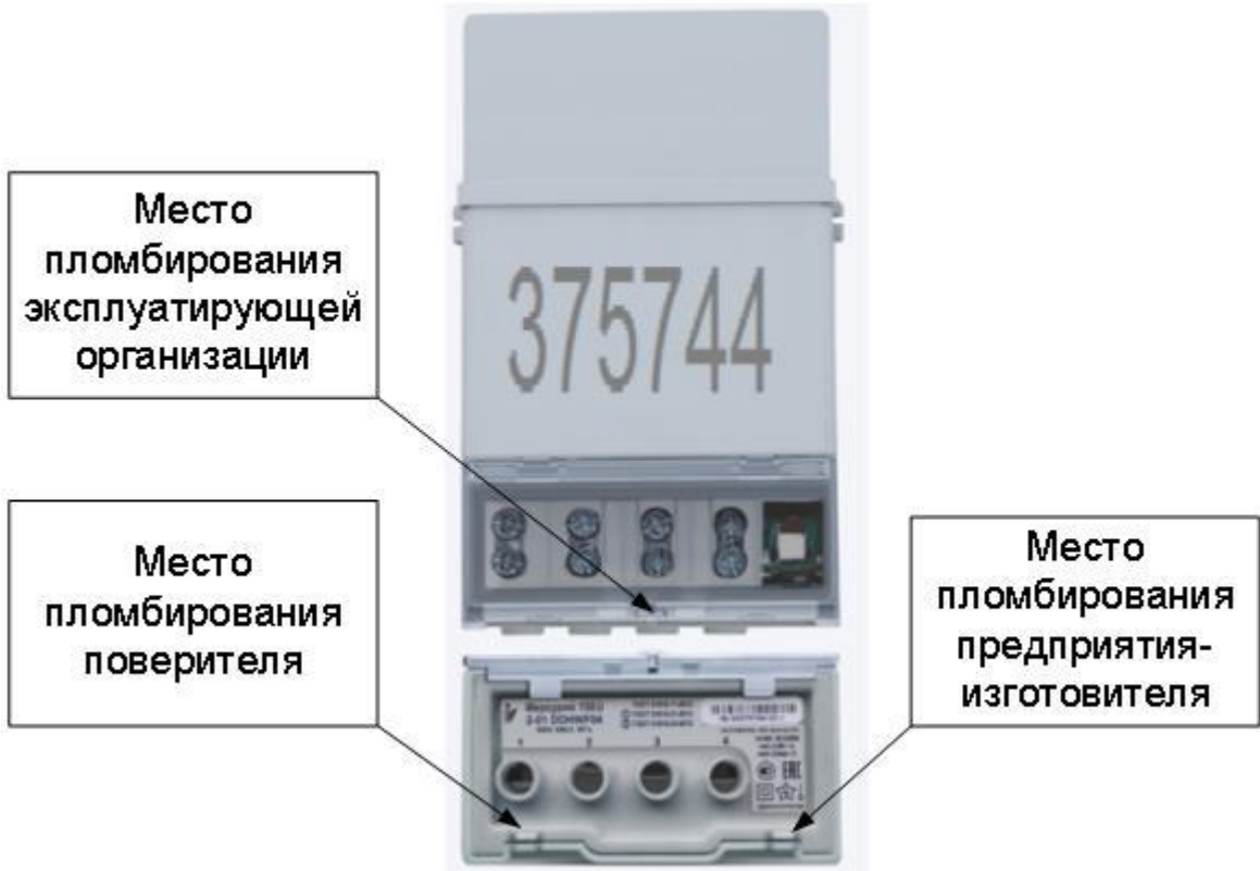
Рисунок 4.2 – Вид счетчика Меркурий 150U с указанием мест пломбирования
