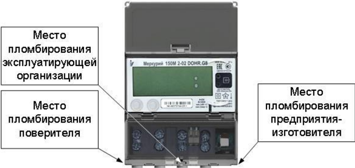
Рисунок 4.1 – Вид счетчиков Меркурий 150М, Меркурий 150, Меркурий 150Х с указанием мест пломбирования
