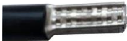
Рисунок 6.1 – Обжим провода СИП наконечником НШВ 16-18
