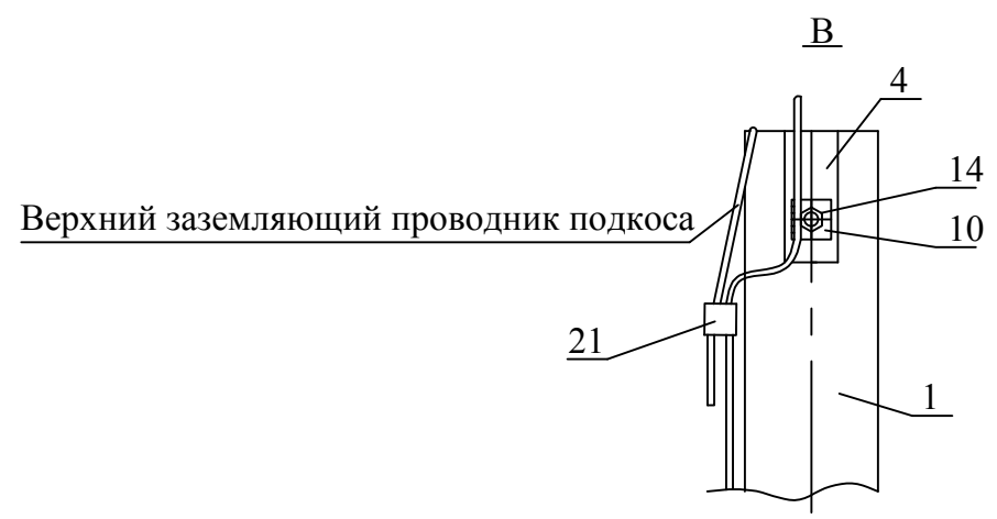
Схема установки опоры на ВЛЗ
