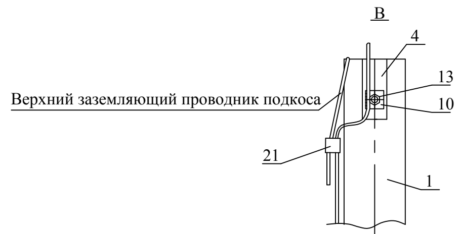
Схема установки опоры на ВЛЗ
