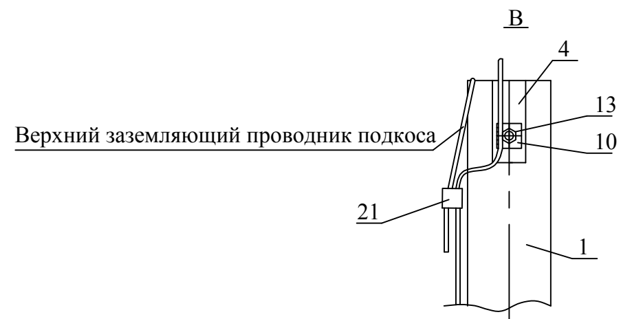
Схема установки опоры на ВЛЗ
